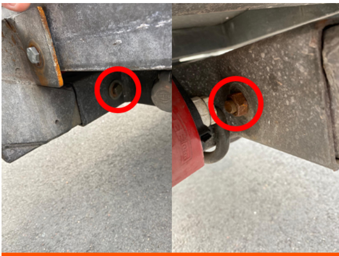
11. Verwijder bout waarmee de dissel aan de onderkant vast zit zodat de dissel los komt. Bewaar de bout en dissel goed.
